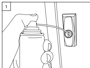
Ölen des Schließzylinders innen. / Oiling the lock cylinder inside.
